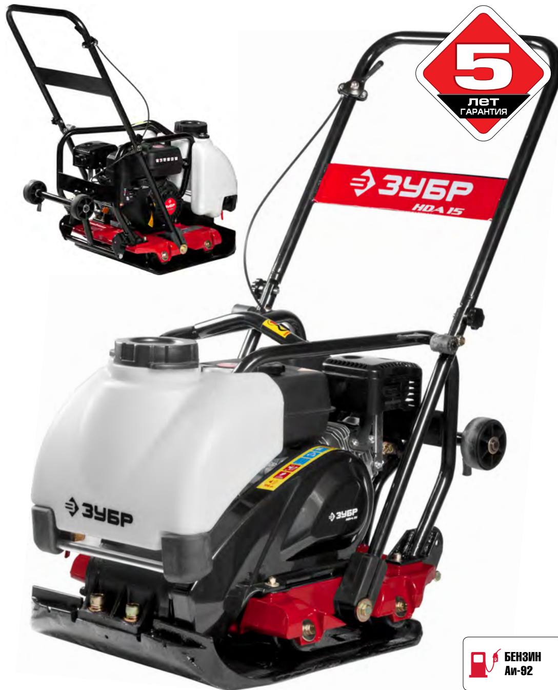
Наличие системы орошения – обязательное условие при уплотнении асфальтобетонных смесей
