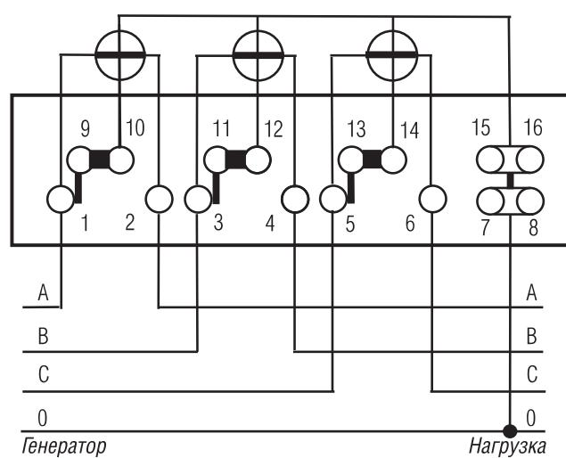
**Рисунок Б. 2.** Схема непосредственного подключения
