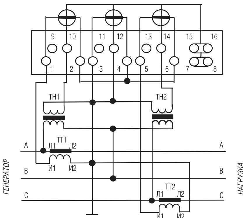
**Рисунок В. 3.** Схема подключения счетчика «Меркурий 230» к трехфазной 3-проводной сети с помощью двух трансформаторов напряжения и двух трансформаторов тока
