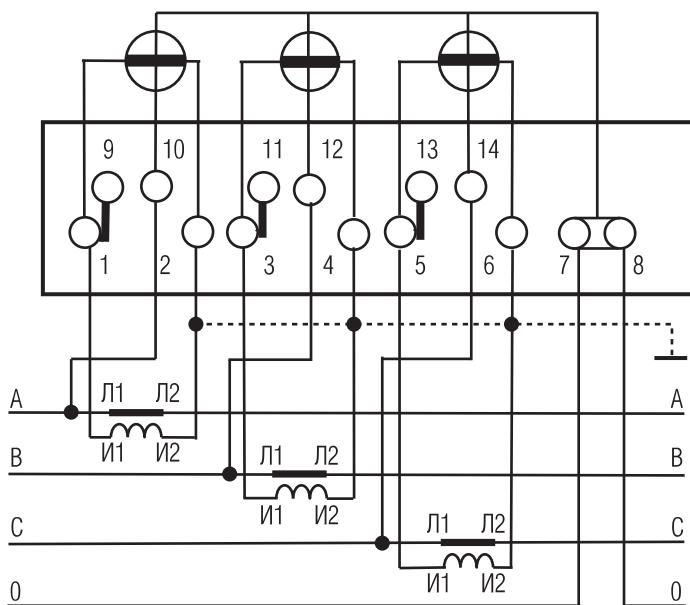
**Рисунок Б. 6.** Схема подключения счетчиков с помощью трех трансформаторов тока для счетчиков «Меркурий 231 АМ, 231 АТ»
