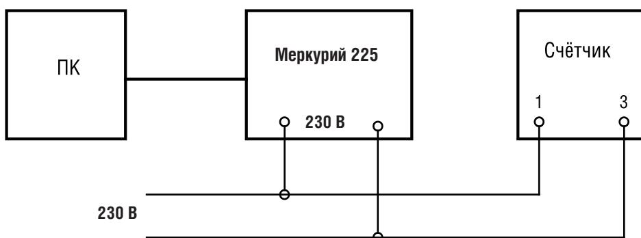
Рисунок В. 4. Mercury 203.2Т Схема для работы с PLC-модемом
