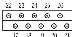
**Рисунок Г.1.** Расположение контактов колодки трехфазных счетчиков «Меркурий 230» для подключения интерфейсов CAN, RS-485, импульсных выходов
