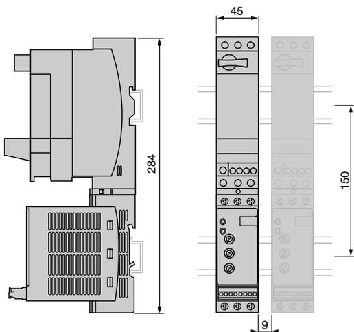
**Комбинация TeSys U (силовой неререверсивный блок с возможностью подключения реверсивного модуля снизу) и ATSU 01N206LT - ATSU 01N212LT**
