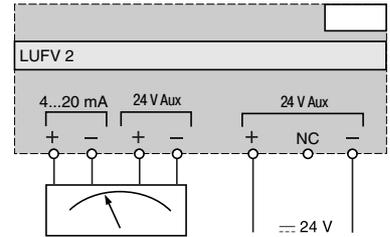
Подключение функционального модуля LUF DA10
