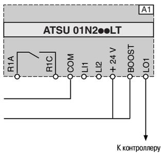
A1: устройство плавного пуска и торможения
