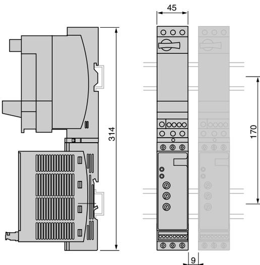
**Комбинация TeSys U (силовой неререверсивный блок с возможностью подключения реверсивного модуля снизу) и ATSU 01N222LT - ATSU 01N232LT**
