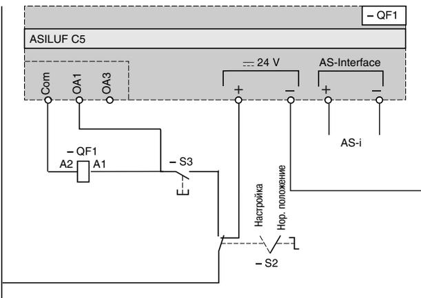
Без применения готового соединения для цепи катушки управления, с многофункциональным блоком управления LUCM
