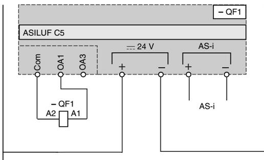
Без применения готового соединения для цепи катушки управления, с местным управлением.
