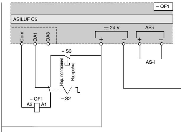
С применением готового соединения LU9B N11C для цепи катушки управления
