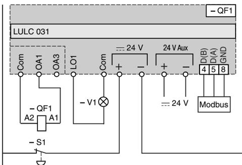
Управление при помощи модуля связи Modbus LULC 032
