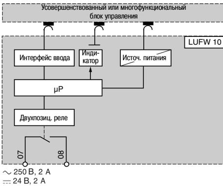
**Модуль индикации нагрузки двигателя**
