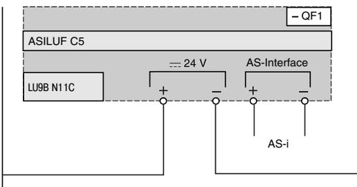
Без применения готового соединения для цепи катушки управления, с местным управлением.
