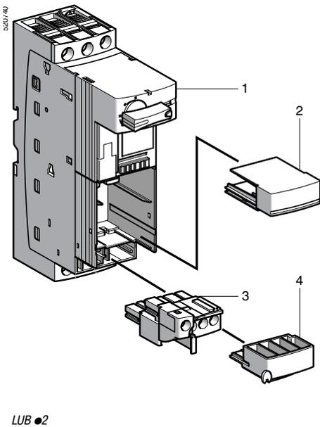
Существуют два основных исполнения нереверсивных силовых блоков, отличающихся наличием втычного клеммника цепи управления:
