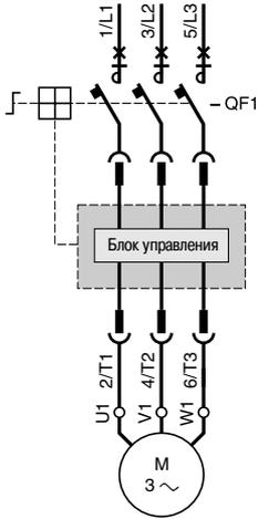
Двухпроводное управление при помощи двухпозиционного переключателя
