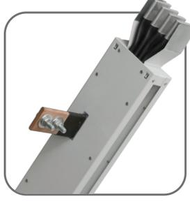
Прямая секция магистральная для бокового подключения трансформатора MTS предназначена для подключения к «сухому» трансформатору и может устанавливаться шинами вертикально и горизонтально, значения L, L1, L2, L3, L4 зависят от марки подключаемого трансформатора.
