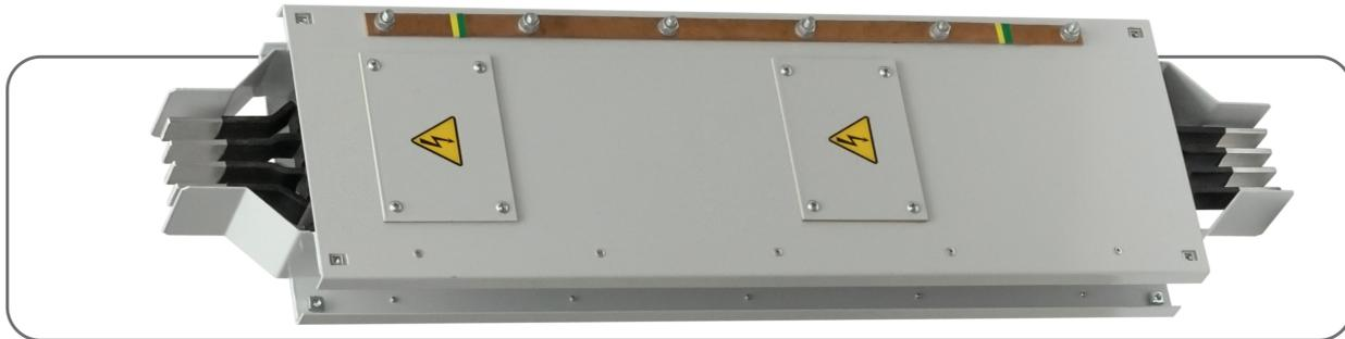
Прямая секция распределительная DS от 160 до 630 А имеет вертикальную и горизонтальную установку, стандартные длины 0,5, 1, 2, 3 м, могут изготавливаться любым размером от 0,5 до 3 мкратно 10 мм.
