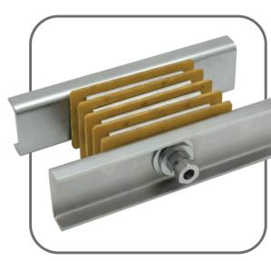
Соединительный блок магистральный MC предназначен для соединения секций и других элементов между собой, в стандартный комплект входят 2 крышки для обеспечения необходимой степени защиты. Момент затяжки срывных болтов - 85Н\*м.
