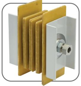
Соединительный блок распределительный DC предназначен для соединения секций и других элементов между собой, в стандартный комплект входят 2 крышки для обеспечения необходимой степени защиты и шины заземления. Момент затяжки срывных болтов - 85Н\*м.
