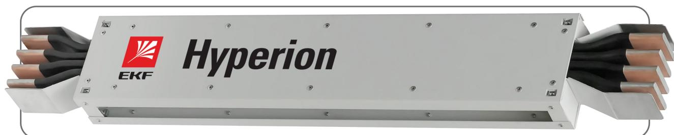
Прямая секция магистральная MS от 800 до 4000А имеет вертикальную и горизонтальную установку, стандартные длины 1, 2, 3 м могут изготавливаться любым размером от 0,5 до 3 мкратно 10 мм.
